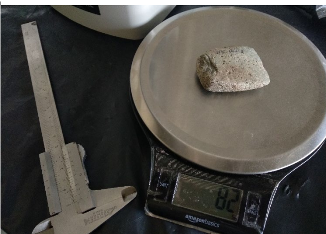
Figura 18 Proceso de obtención de la masa del artefacto a través de una alanza electrónica
